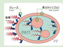
※2 クレーズ: 衝撃入力時に発生する微小なひび割れ Generation of microscopic cracks when energy is input in an impact.
