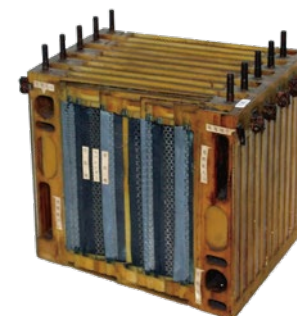
亜鉛空気蓄電池のカットモデル Cutaway model of zinc-air battery
