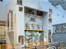
Prensa de 600 toneladas producida por Danly Co.
