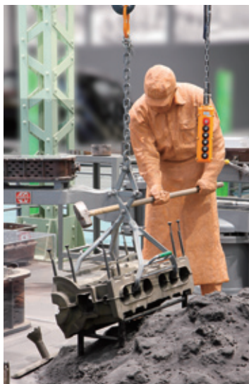
冷えて固まったら、砂型や中子を壊してシリンダー・ブロックを取り出す。
