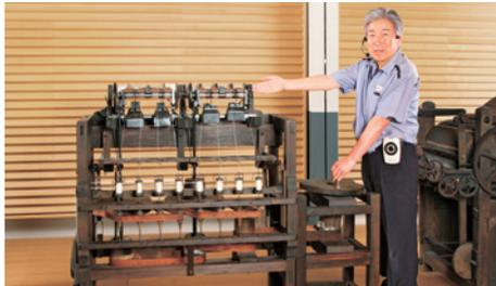
動力により稼働し、粗糸の引き伸ばしも機械化された
