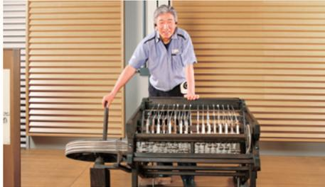
右手でハンドルを回しながら、左手のプレッサーで粗糸の引き伸ばし加減を調整する
