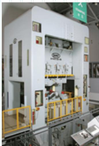
元町工場へ2ライン(14台)導入されたダンリー社製600tプレス機
