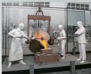
溶かした鉄をシリンダブロックの砂型に流し込む様子
