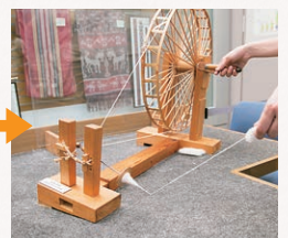
練を使い「引き延ばし」「撚り掛け」「巻き取り」
