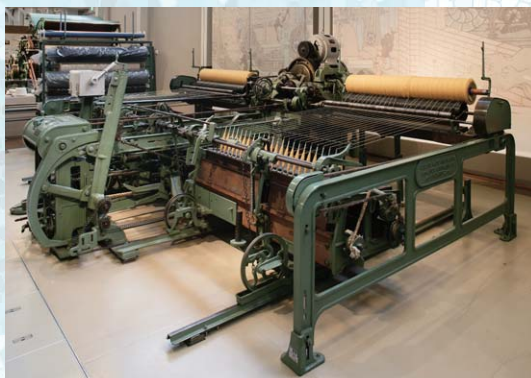
輸入機と同世代の自動ミュール精紡機(1839年発明)
