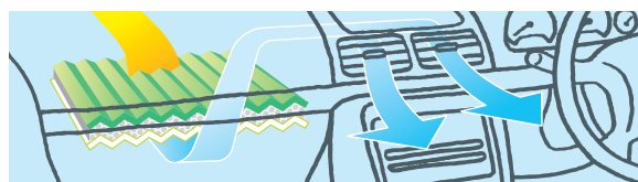
脱臭キャビンエアフィルターの取付位置と空気の流れ
