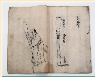
気砲記(使用書)(国友藤兵衛一貫斎著 1819) 自転車タイヤに空気を入れるようにして銃床に圧縮空気を蓄える。
