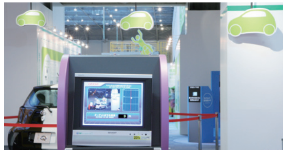
天井から吊り下げられた「クルマボード」にミリ波レーダーを当てると、それぞれの距離が表示される
