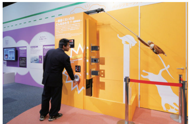
3種類の衝撃吸収構造体にサルのぬいぐるみをぶつけてそれぞれの衝撃力を測定
