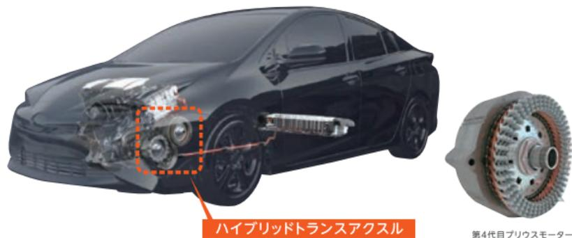
第4世代プリウスの開発にあたり、高燃費を達成するために、ハイブリッドトランスアクスルの基本構造から見直しました。開発の目的は大きく二つ。一つ目は小型・軽量化、そして二つ目は損失低減です。こちらの展示では主に新開発モーターの小型軽量化・損失低減に関して説明します。
