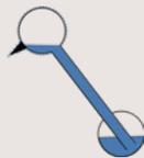
④ 下側の容器のガラス管の先端が液面から出た瞬間に下側の気体が上側に流れ込み、逆に上側の液体が下側に流れ落ち、両側の気体の圧力は等しくなる。
