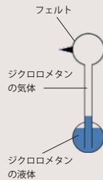
② 相対的に下側の容器の温度が高い状態となり、液体が気化することで容器内の圧力が上昇するため液体を押し上げる。
