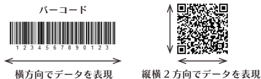
バーコードと違い、縦横 2 方向でデータを表現しているため、数字のみの場合、最大 7,089 桁、英・数・記号、かな、漢字まで大容量で収納できます。
