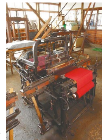
宮城県栗原市若柳の工房で 今も使われている 豊田式鉄製小幅動力織機(Y式)。
