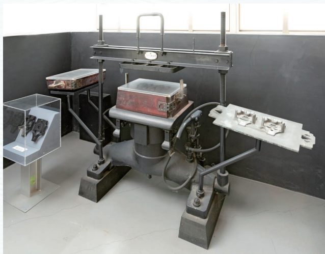
(写真3) 鋳造用砂型のC11型生型造型機(複製)
