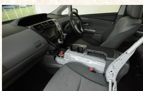
(写真12)センターコンソール内 のプリウスα用リチウムイオン電池パック
