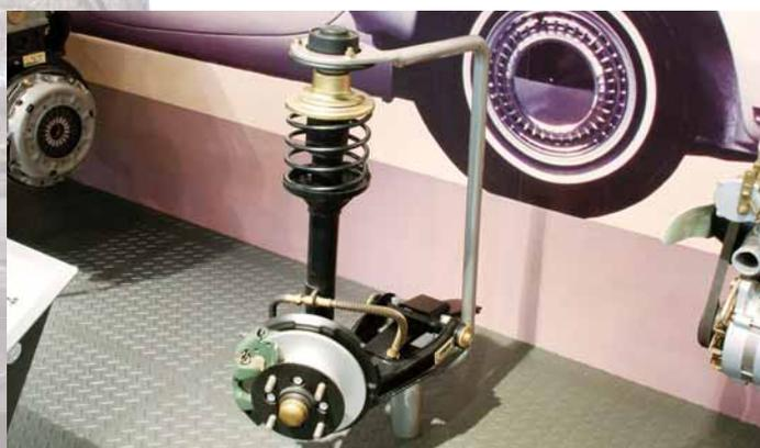
マクファーソン・ストラットタイプ前輪サスペンションは独立懸架方式サスペンションの1種で高速走行時の安定性や軽量化などの目的から独自に開発、国内で最初に量産化された。
