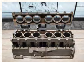
写真2 A型エンジンブロック内部
