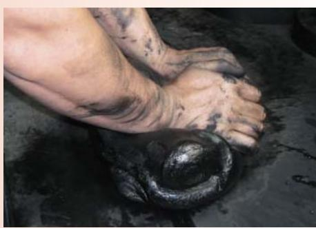
30~40分ほど機械で混練した後、煤と膠をさらに混ぜ合わせると同時に空気を抜いて墨玉をつくる。
