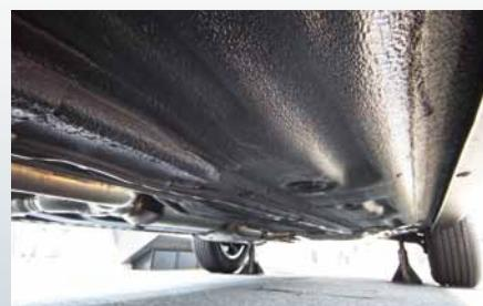
フロアメンバーをフロア上面に収め床下をフラット化
