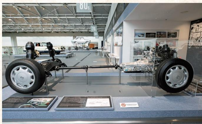
シャシーにみる源流対策：高レベルの静肅性実現をめざして、トランスミッションからデフまでの駆動部品を一直線に配置、回転による振動を少なくしました。
