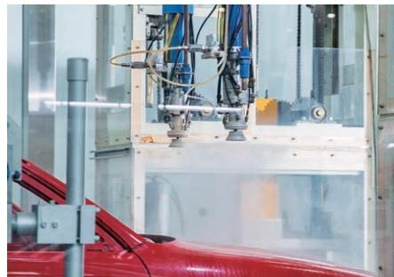
静電塗装により、塗料の損失を約20%以下に抑えることに成功しています。
