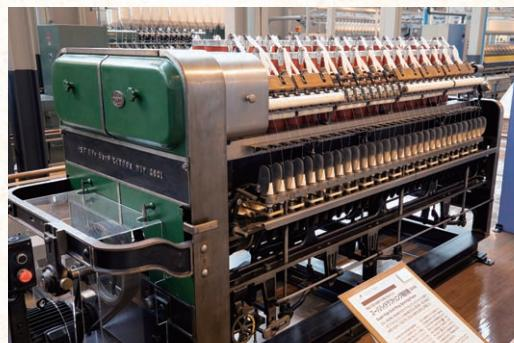
写真2:スーパーハイドラフト リング精紡機 RU型
