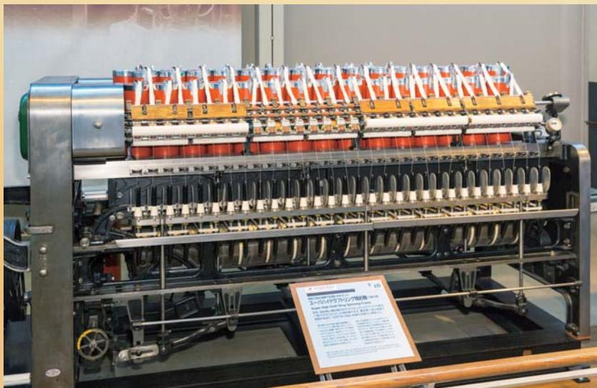
綿糸づくりは、原綿の纖維を解きほぐし不純物を取り除いて、1本1本の纖維を平行に揃えてスライバー（太い紐状の纖維束）をつくった後、それを引き伸ばして撚りをかけていきます。通常、混打綿、梳綿、練条、粗紡、精紡の工程を経て行われますが、粗紡工程と精紡工程の2回に分けて行っていた引き伸ばしドラフト工程を、一度に行えるようにしたのが、スーパーハイドラフト リング精紡機です。
