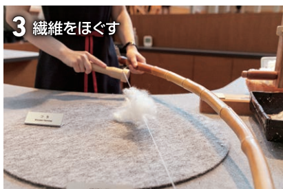
「綿打ち弓」の弦の振動で綿の繊維をほぐします。
