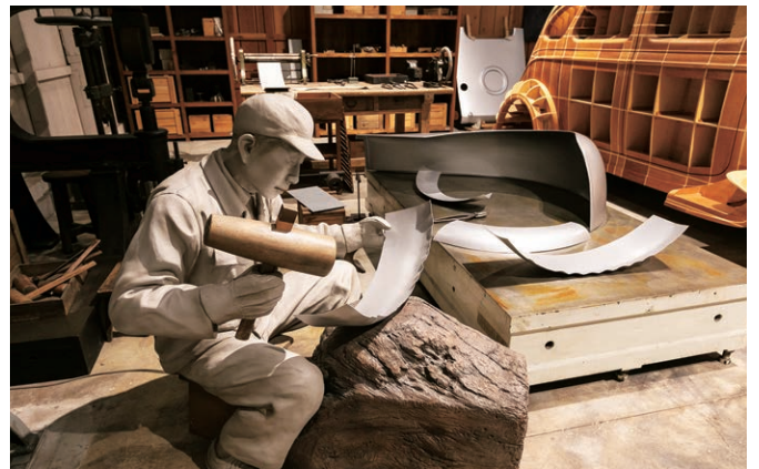
手叩きだけで作っていった試作車のボデー
