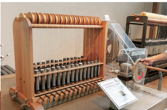
ガラ紡機 （手廻しタイプ） レバーを手で回すことで 稼働します。
