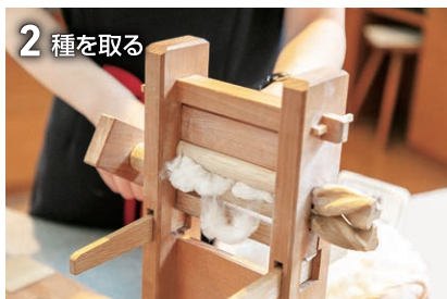
「綿くりろくろ」を使って、綿の種を取り除きます。
