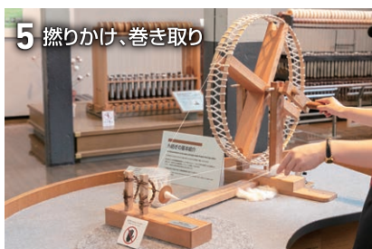
引き伸ばした繊維を強くするためにねじることを「撚りをかける」といいます。最後に出来上がった糸を巻き取ります。
