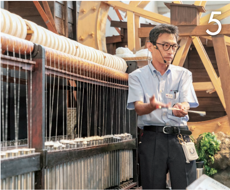
ガラ紡機（動力タイプ） 水車の回転を利用して稼働します。
