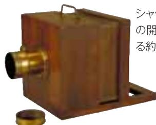
シャッター機能や絞りはなく、レンズキャップの開閉により数十秒程度露光させて撮影する約150年前の湿板用箱型カメラ。
