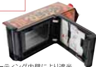
アルミコーティング内壁により遮光性の高い焼酎バックに、撮影直後に写真が見られるインスタントフィルムを接合したピンホールカメラ。
