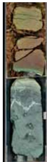
基盤岩である玄武岩（下）と、その上の堆積岩（上）との境目が明瞭に現れた地層。狙い通りの試料がピンポイントで採取できたため「奇跡のコア」と呼ばれる。
