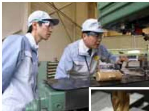
回転する切削工具やテーブルを操り、金属を100分の1ミリ単位で切削加工するフライス盤。コンピュータ制御となった今でも、手作業の感覚を知るためにマンツーマンで操作を指導する。
