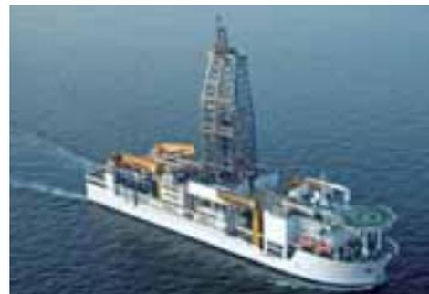
「ちきゅう」は、マントルや巨大地震発生域への大深度掘削を可能にする世界初のライザー式科学掘削船。
