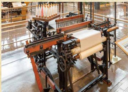
図1: 豊田式鉄製小幅動力織機（Y式）
