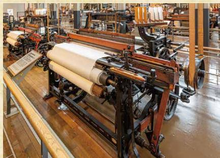
図2: 豊田式鉄製広幅動力織機（N式）
