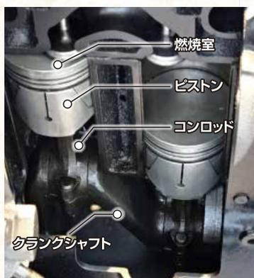
写真3 エンジン内部(R型エンジン)
