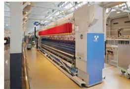
紡績糸 管糸 リング精紡機(糸作りの最終工程)
