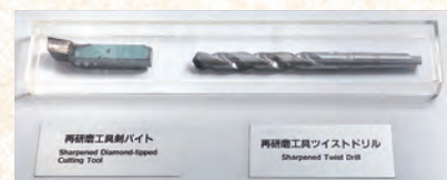
（写真3）再研磨工具（高速鋼のバイトとドリル）
