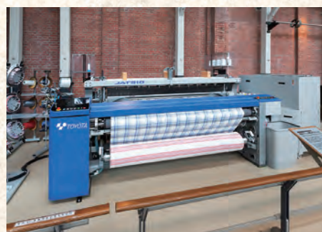
(写真3)電子開口装置付きエアジェット織機 (2023年製、カーテン生地)
