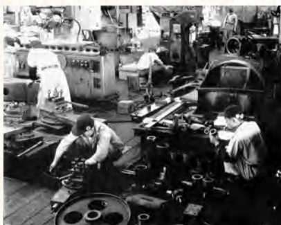
(写真5) 工機工場に於ける機械の修復作業
