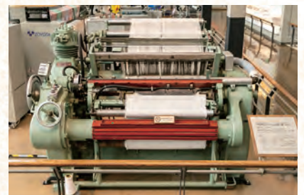
(写真4) マクスボ社と同型のエアジェット織機
