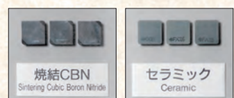
(写真6) 焼結CBNチップ (写真7) セラミックチップ
