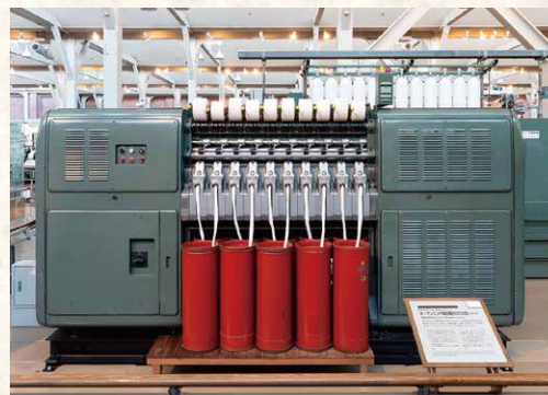
(写真3) ローター式オープンエンド精紡機BD200型
