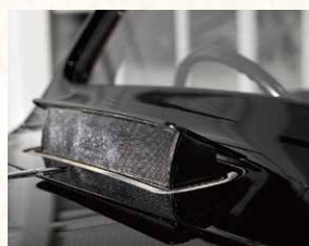
(写真8)外気導入口 車室内の空気循環に配慮した当時の最新装備
