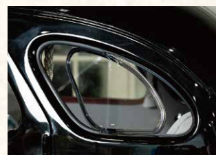
(写真9)後席窓の開閉機構
