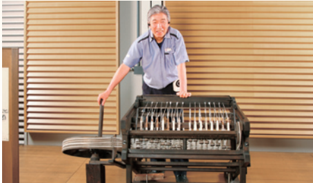
右手でハンドルを回しながら、左手のプレッサーで粗糸の引き伸ばし加減を調整する 大英科学博物館(英国)が所蔵していた1770年の製造品をイギリスで複製
