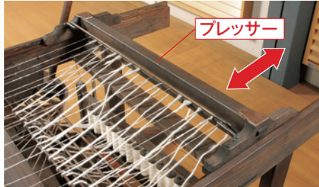
粗糸を上下に挟むプレッサーを手前に引いて、引き伸ばす
