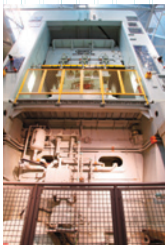
地下に動力部分を納めることにより、安定性に優れ高速稼働ができるため、品質と生産性が向上
