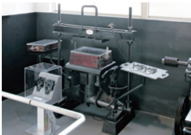
鑄型造型機(1927年・複製) 国産初の鑄型造型機。G型自動織機の部品を鑄造した際の砂型とともに、創造工房で展示中。
