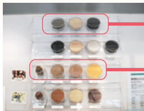
鋳物砂 粘土分の多い山砂、通気性に優れた合成砂など、時代によって鋳物砂も進化している。
