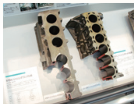
シリンダー・ブロック (左) 1934年開発のA型エンジン用シリンダー・ブロックは厚肉で、後工程で機械により穴開け加工していた。 (右) 1992年開発の2JZ-GE型エンジン用シリンダー・ブロックは薄肉で、中子を用いた細い貫通穴もある。
