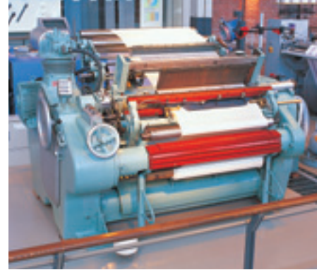
マクスボ エアジェットルーム MP-9型(1974年製)
