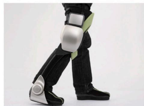
ボリオ等で片側の下肢に麻痺を持つ方が、従来の補装具で歩くと関節の自由度が制約され、「歩きにくくて疲れる、転倒の不安」等のご苦労があった。これらの問題を解消するために、自立歩行アシストでは、モータで膝の動きをアシストする。「姿勢センサ」や「荷重センサ」で膝を制御し、併せて体重を確実に保持できる構造の採用により、違和感のない歩行と転倒リスクの低減を実現した。
