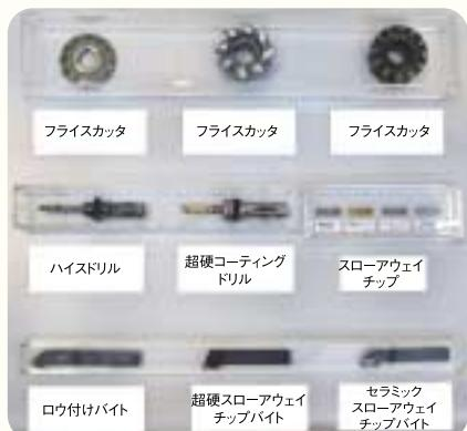
1950年までの切削工具の材質は高速度鋼(ハイスピードスチール:略称ハイス)が主流。1950~60年代には機械加工の高速化と精度の向上に伴い、工具の寿命、精度の向上が図られ、1954年超硬合金、1959年Mo系高速度鋼、1961年セラミックの工具を導入しました。また工具取り換え時間の短縮のため、工具の刃先(チップ)だけを交換する使い捨て(スローアウェイ)タイプの工具を導入。1970年代には炭化チタン、ダイヤモンドなどを用いた長寿命、高能率工具を導入しました。
