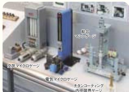
創業当時、加工品の寸法測定にはノギス、パス、マイクロメータなどの汎用の測定具を使用し、「穴は大きめ、棒は小さめ」程度の精度管理で、加工精度は作業者に依存していました。1950年代に入ると精度の高い機械の導入に伴い、専用の限界ゲージやエアマイクロメータなどが導入され、迅速な測定が可能になりました。1970年には、寸法の変化を電気量に変換して表示する電気マイクロメータを導入しました。
