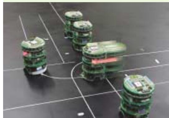
〔自律分散ロボット〕生物が隊列を作り行動する習性はない、協調行動を可能にした小型ロボット。たとえば直線上に障害物があれば、先頭のロボットが停止。後続のロボット群もそれが停止する。自律しながらもお互いに連絡を取り合い集団で一定の行動をとる。
