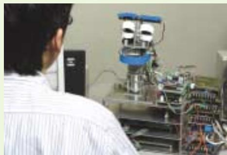
〔CRF3〕福田先生いわく「キーボードを使っての入力は時代遅れ」なのだと。誰にでもロボットを使えるようにするには音声認識が最適。そこで人の言葉を理解し命令を実行する対話型のロボットを研究開発中。完成時は愛嬌のある顔になる予定。
