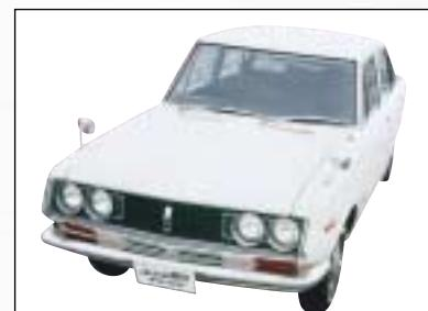
プラスチック製ラジエータグリルを採用したマークII RT60D型(1968年)。
