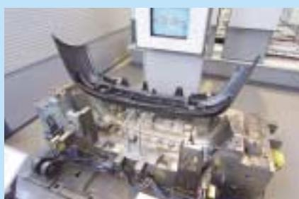
射出成形機用金型とコロナ用ポリプロピレン製バンパ
