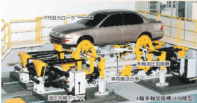
**4輪3方向加振試験(1988年頃)**
