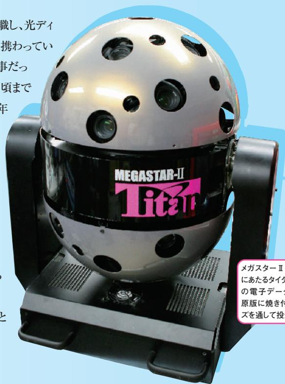
メガスターⅡの4号機にあたるタイタン。恒星の電子データを恒星原版に焼き付け、レンズを通して投影する。
