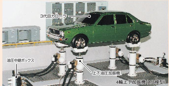
**4輪上下加振試験(1975年頃)**
