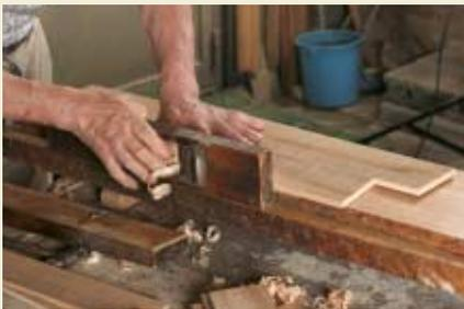
【はぎ加工】接合面となる側面を鉋で慎重に削る。何枚もの板を接着し、はた金で固定して乾燥させると、一枚の大きな板となる。
