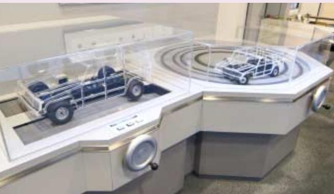
フルタイム4WDにはドライブシャフトの前・後・中央の3カ所に差動歯車装置(デフ)が使われています。エンジンの力は、中央のデフによって前・後方向に振り分けられ、また前後のデフで左右の各タイヤに分配されます。デフは、クルマが曲がる時に発生する前後左右のタイヤの回転差を吸収し、スムーズに曲がることを可能にします。
