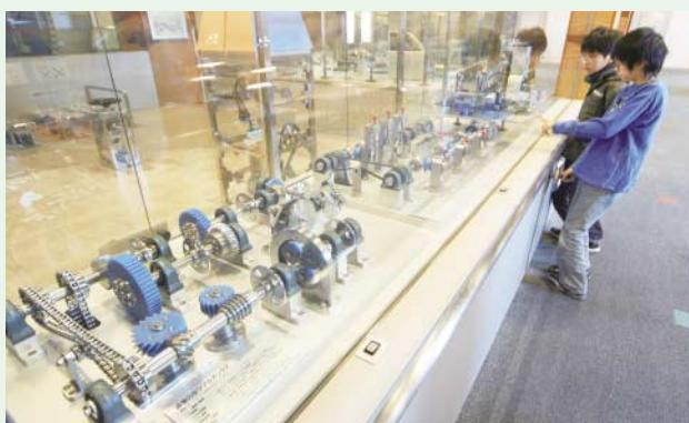
ずらりと並ぶサンプルボックスにはどれもハンドルなどが付いていて、実際の動きを確かめることができます。たとえば、リンク機構の応用例は自動車のワイヤー。ぐるぐるハンドルを回せば、回転軸に取り付けられたロッドが動いて、ワイヤーブレードの付いたアームが左右に動き、おなじみのワイヤーの動作になります。写真は歯車のサンプルボックス。さまざまな機械に使われるいろいろな歯車の働きを、装置に触れて楽しく体感できます。
