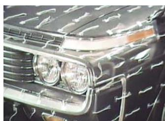
■1980年代 実車による風洞実験
