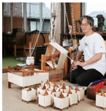
組み上げる糸の長さ和本数を調整する経尺（へいじゃく）工程。職人たちは“下ごしらえ”と呼ぶ。慣れないうちは糸が絡んだり、糸の摩擦で指を切ったりすることもあるという。
