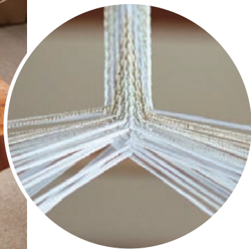
中内工房の場合、帯締めを使う組玉の数は約70玉、ネクタイであればおよそ100玉。糸を巻きつけた組玉の重みで糸に適度なテンションを与える。
