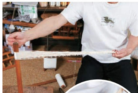
必要な玉数の糸を用意し、この後、組玉に巻いていく。同じ帯締めでも強く締めると糸の消費量が増えるため、組子一人ひとりのクセに合わせて長さを変える。
