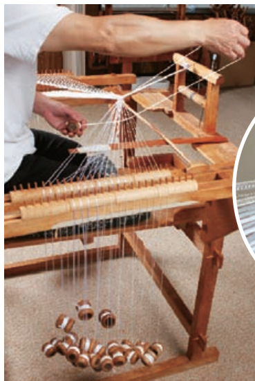
中内工房の場合、帯締めを使う組玉の数は約70玉、ネクタイであればおよそ100玉。糸を巻きつけた組玉の重みで糸に適度なテンションを与える。
