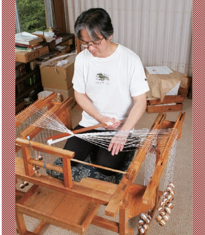
何本もの細い糸を組んで作られるくみひも。組台の上で左右に振り分けた糸を規則的に移動させ、交差した部分を竹べらで叩いて締めていく。トントンと打つ強さ加減でくみひもの弾力性が変わり、組子（くみひも職人）毎にそれぞれのクセがある。
