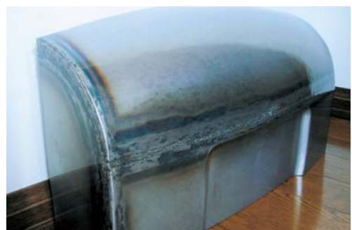
木製ハンマーなどを使用して製作した作品。板の厚みに偏りなく曲げるのが匠の技。
