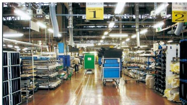
無駄をなくすため、生産工程に合わせて部品のレイアウトを変更したカイゼン事例。
