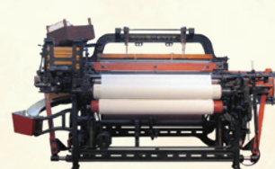
Telar automático Toyoda con cambio ininterrumpido de lanzadera (Telar automático Tipo G)
