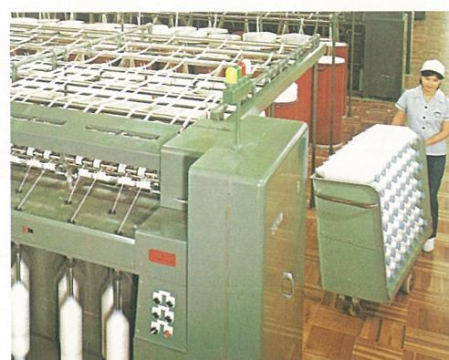
写真16 人手による粗糸満ボビンの運搬
