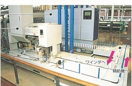
写真17 糸ボビン（管糸）搬送装置
