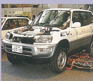
自動車館ではさらに、「RAV4 EV」を期間限定で展示しています。充電量の大きい「ニッケル水素バッテリー」、効率のよい「交流同期モーター」および「回生ブレーキ」により1充電当たりの走行距離215km（10・15モード）と最高速度125km/hを達成しています。
