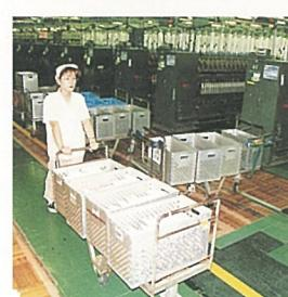
写真18 人手による糸ボビンの運搬
