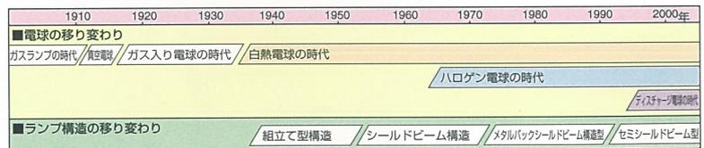
図30：ヘッドランプの移り変わり
