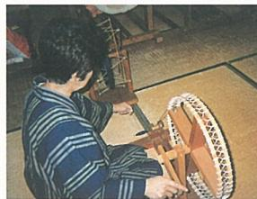
写真20 管巻き作業
