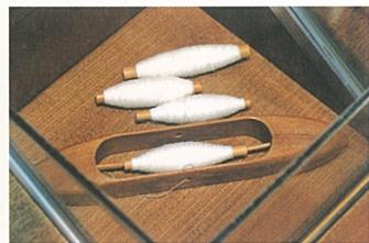
写真21 管巻きを収めた杼と管巻きしたよこ糸
