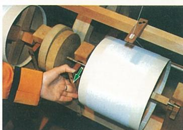
写真3 糸杼の取り替え機構
