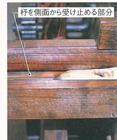
写真9 よこ糸切断停止装置
