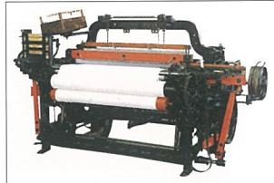
写真1 無停止杼換式豊田自動織機(G型)
