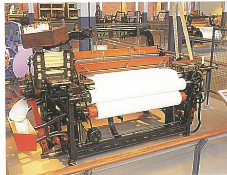
写真7 無停止杼換式豊田自動織機 (G型)
