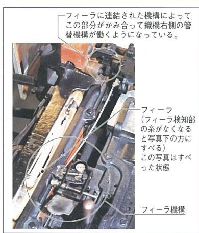
写真11 フィーラと管替誘導装置
