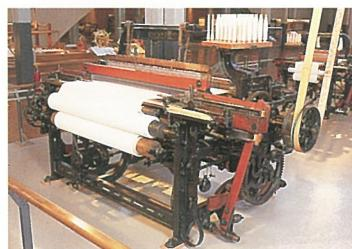
写真12 豊田式鉄製広幅動力織機（N式）
