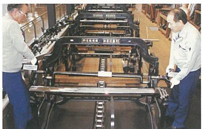
写真20 サブ組付けされたクランクシャフトの組付作業
