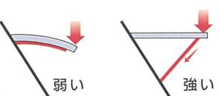
同じ細い棒を用い、一方には曲げ方向、もう一方には圧縮方向の力を加え、それぞれの強度を比べたもの。同じ材料でも組み合わせ方を変えるだけで強い構造ができる。
