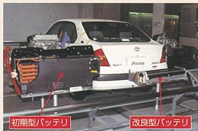
改良型バッテリは形状変更、極板の構成や材料の改良により、体積を約60%低減、重量を約30%軽量化しました。両者を比較できるように展示しました。
