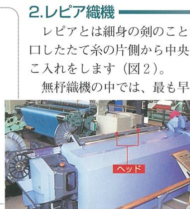
写真2 レピア織機のよこ入れ機構模型
